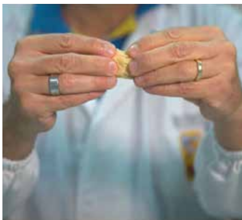
Uno dei controlli in laboratorio dell'elasticità del glutine.
